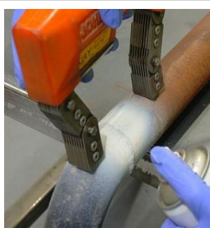
Магнитный контроль (МПК)
